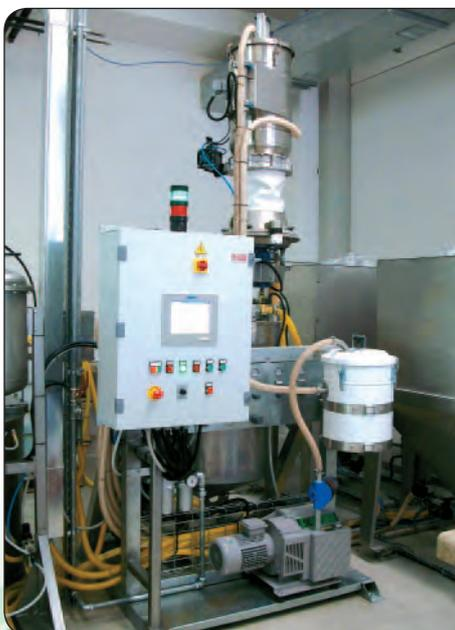
Sistema di trasporto e dosaggio con gestione di ricette per 4 additivi chimici, realizzato con pompa ad alto vuoto in un'industria del settore aeronautico.
